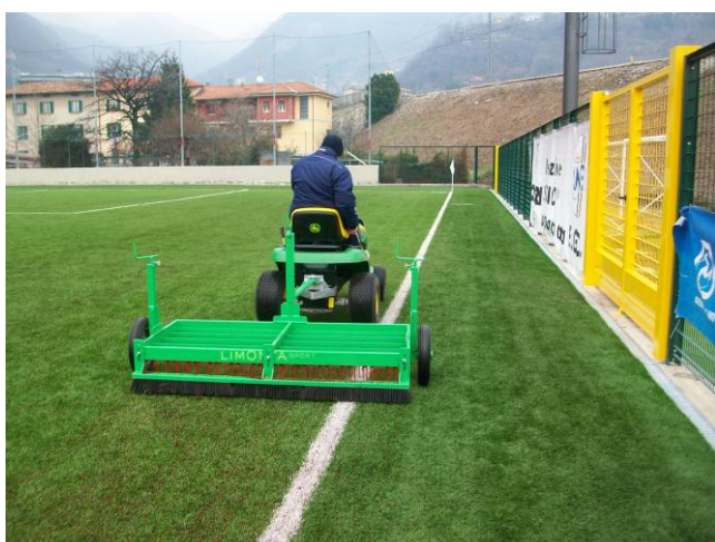
Operazione di de compattazione/spazzolatura
