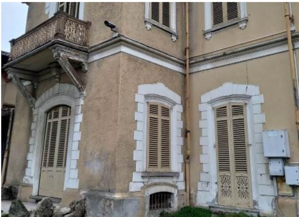
Sostituzione di una vecchia telecamera IP Hikvision con una H5 Multisensor con tre ottiche 15C-H5A-3MH, il punto di ripresa deve essere spostato più in basso e ad angolo.
